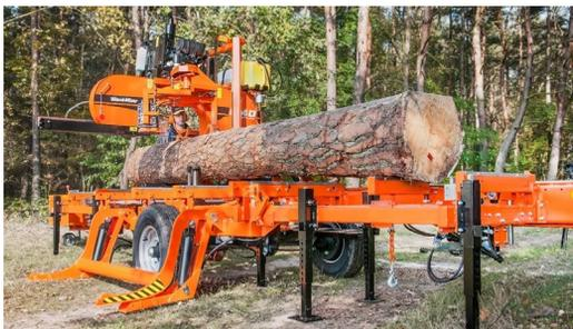
Mobile LT40 mit M Sägebett. Auch bei mobilen Sägen kann mit Verlängerungen gearbeitet werden. Im Gelände ist allerdings der Aufbau aufwendiger als auf befestigtem Untergrund.
