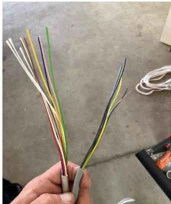
Das 4-adrige Kabel aus dem Vorschub in den Elektrokasten der Maschine legen
