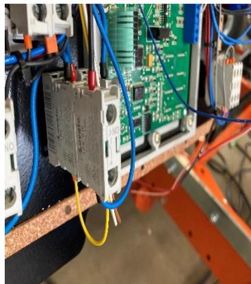
Anschließend ein Kabel vom anderen Kontakt (Nummer 4) des Joysticks auf den Ein/Aus-Schalter des Vorschneiders klemmen.
