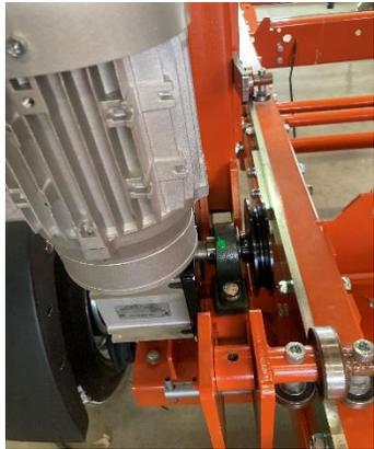
Motor am Sägekopf befestigen
