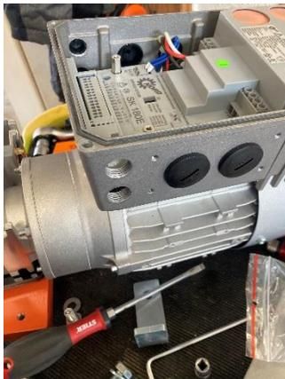
Deckel aufschrauben und Kabelverschraubungen einschrauben
