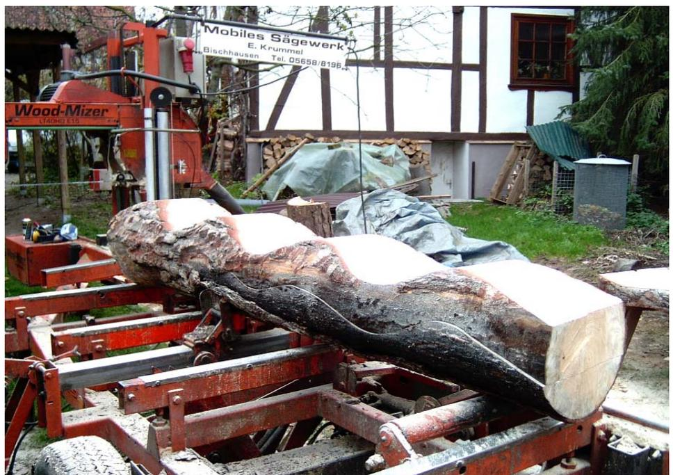
*durch Zusatzeinrichtung Wellen schneiden*
