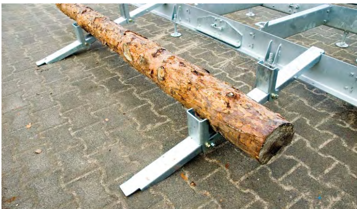
Laderampen für LT10 und LT15 helfen schwere Stämme auch allein auf die Säge zu laden.
