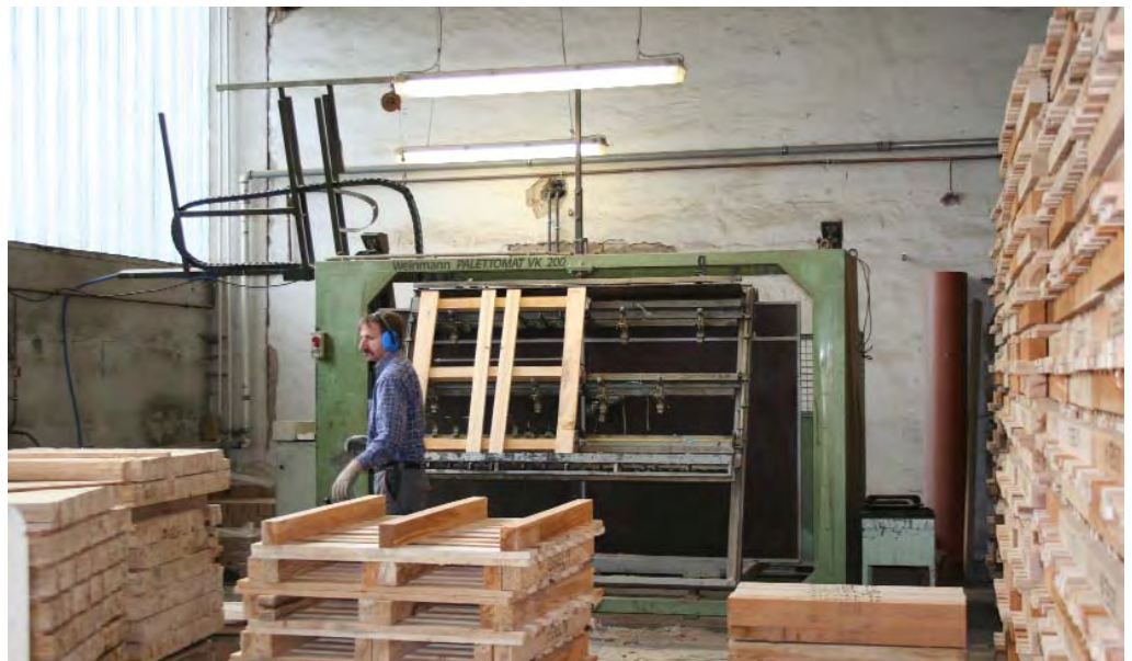
Nur die Standardpaletten werden automatisch genagelt. Alle anderen Palettentypen werden in Handarbeit hergestellt.
