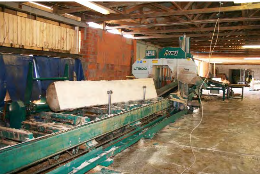
Laden, Drehen, Schneiden und der Abtransport der Schnittware wird zentral von der Bedienerstation aus gesteuert. Sie ist bequem in einer beheizten Kabine in erhöhter Position untergebracht.
