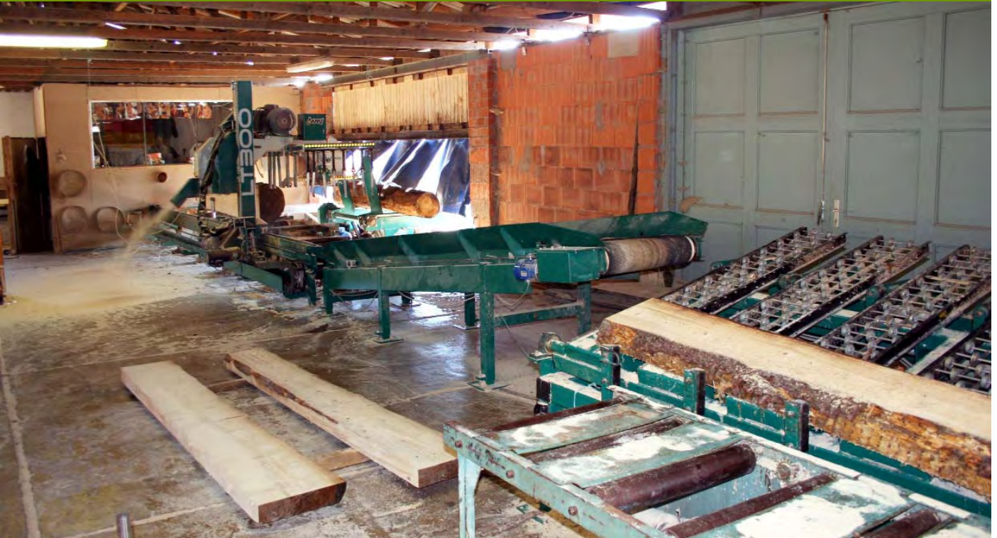
Die LT300 als Herzstück der Produktion. Mit Längs und Querfördertisch wird das geschnittene Holz für die Weiterverarbeitung von der Maschine weg transportiert. Der Zuführtisch wird von außen bestückt.
