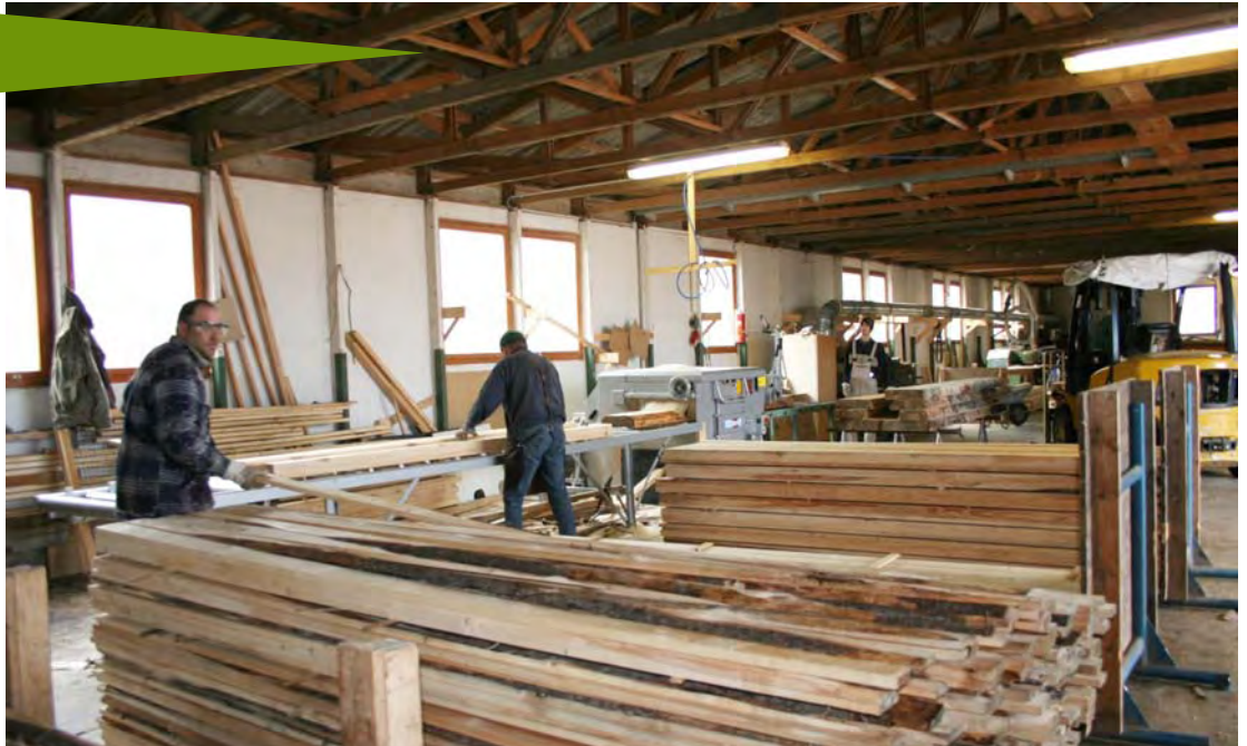
Die aufgetrennten Bohlen werden sortiert und auf Länge gekappt.
