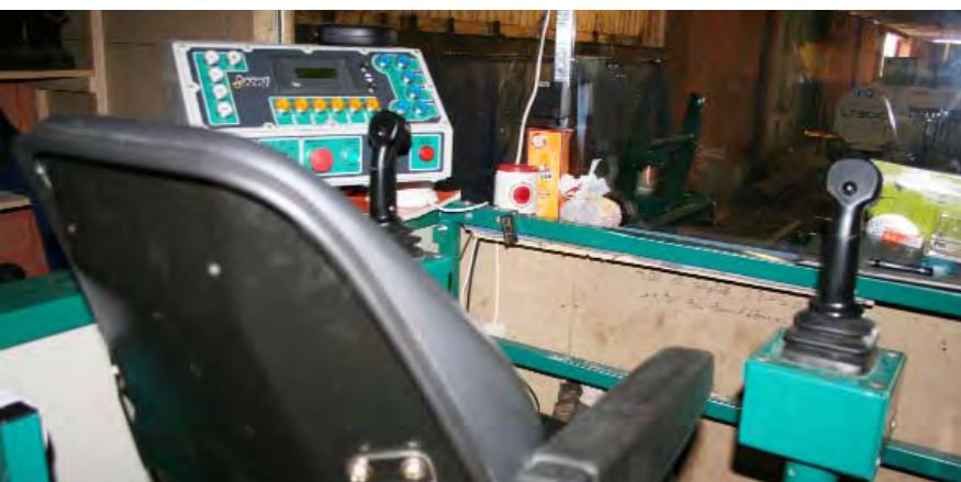
Laden, Drehen, Schneiden und der Abtransport der Schnittware wird zentral von der Bedienerstation aus gesteuert. Sie ist bequem in einer beheizten Kabine in erhöhter Position untergebracht.
