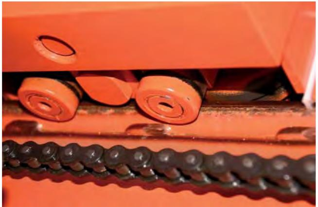
einem stillstehenden oder unruhig laufenden Sägeschlittenlager gearbeitet, kann der Rundstahl einlaufen, so dass mit der Säge nicht mehr maßgenau geschnitten werden kann. Die einzige Lösung ist dann ein neuer Rahmen für die Säge. Wir bieten die Sägeschlittenlager bis zum 15.5.2010 besonders günstig an:
