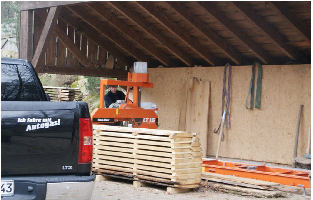
Die LT15 steht in einem Unterstand. So arbeitet Matthias Berthold witterungsgeschützt, hat aber trotzdem einen guten Materialfluss.
