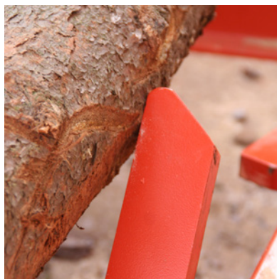
Bei gedrehter Seitenstütze wird der Stamm am höchsten Punkt geklemmt.
