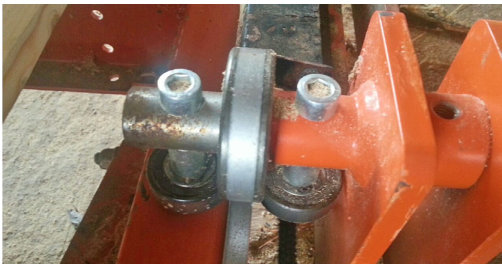
Nach dem Abschrauben der Abdeckung sieht man die Innensechskantschrauben, die zum Einstellen gedreht werden.
